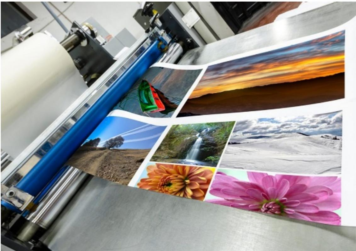
Изображение может наноситься двумя способами. В первом случае предварительно создается зеркальный рисунок на бумаге, его переносят на ткань, используя термопресс. Второй способ предлагает нанесение чернил непосредственно на ткань, а затем ее нагрев. В процессе нагрева и последующего охлаждения краска принимает твердую форму, запекаясь на ткани.
